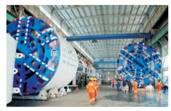
中铁隧道装备制造公司生产的中国中铁三号、四号盾构机
